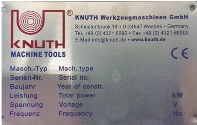
Das Maschinentypenschild befindet sich am Schaltschrank der Maschine. Auf dem Maschinenschild befinden sich Angaben zum Maschinentyp, der Seriennummer, das Baujahr, die elektrische Anschlussleistung, die Anschlussspannung sowie die Netzfrequenz.
